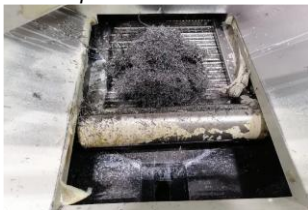
Figura 4 Sobrantes metálicos en máquinas
