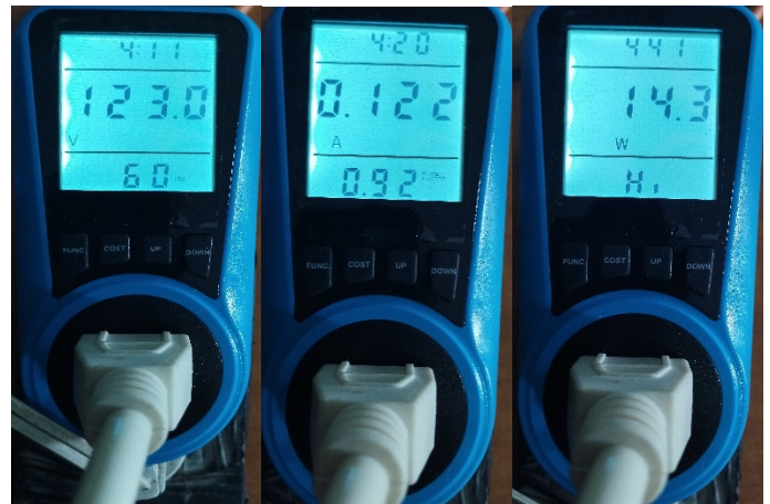
Figura 22 Mediciones de parámetros eléctricos de un medidor comercial.
