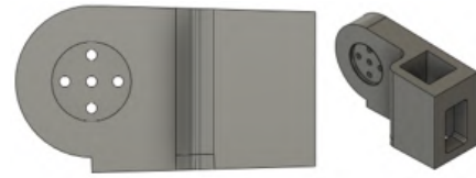
Figura 12. Estructura para quinto grado de libertad Fuente. Elaboración propia.
