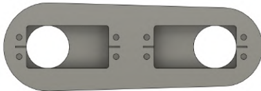
Figura 10. Eslabón para tercer y cuarto grado de libertad. Fuente. Elaboración propia. Entorno de desarrollo: Fusion 360 de Autodesk
