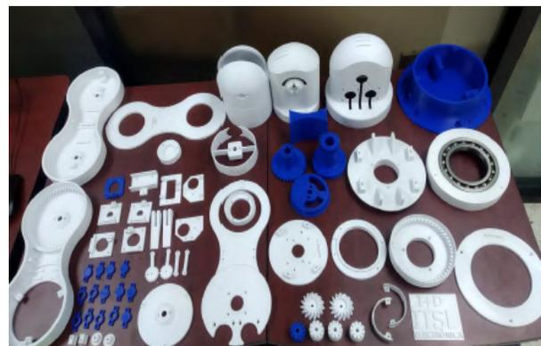
Figura 11. Todas las piezas del robot terminadas
