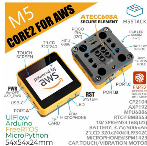
Figura 2. Especificaciones del módulo Core2 for AWS
