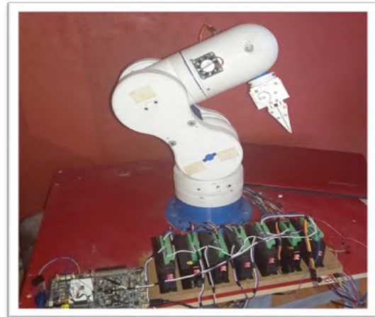
Figura 16. Drivers de potencia cableados para el control de los NEMA 17.
