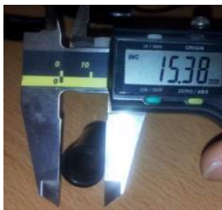
Figura 9. Diámetro externo del tubo.
