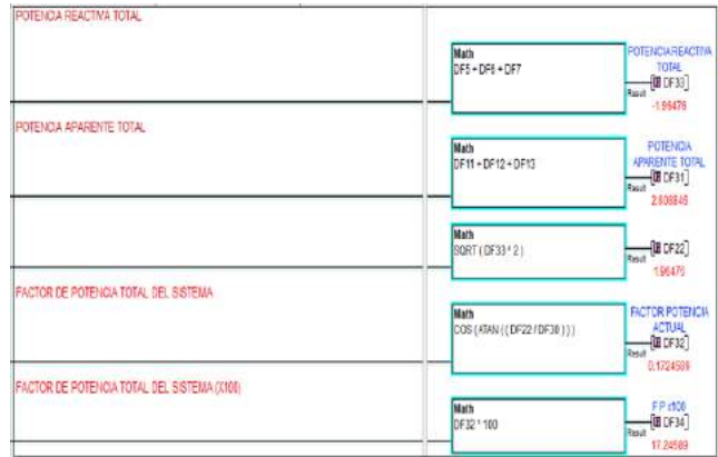
Figura 8. Programación para la obtención del factor de potencia actual del sistema, y almacenada en localidad de memoria DF32 del PLC.
