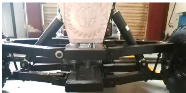
figura 6 Suspensión con varilla roscada.
