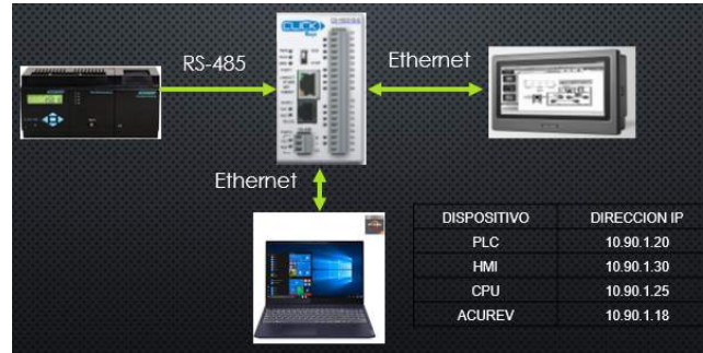
Figura 5. Direcciones IP utilizadas para PLC, HMI, CPU y AcuRev
