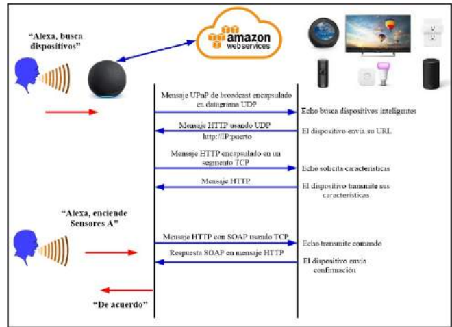
Figura 2. Comunicación entre el asistente Alexa y el ESP32-WROOM
