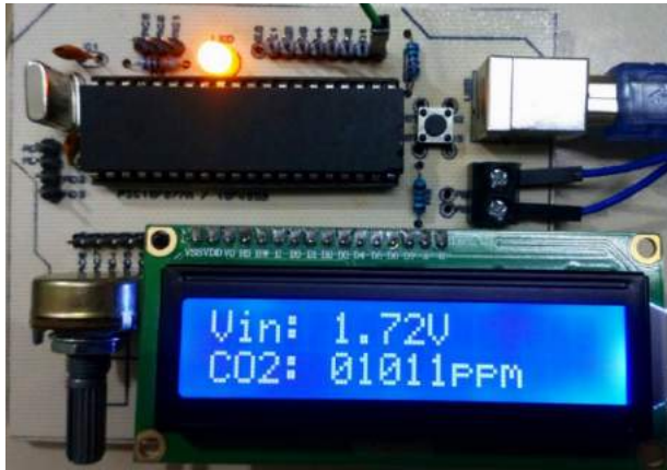
Figura 14. RNA mostrando el acondicionamiento del MG811.
