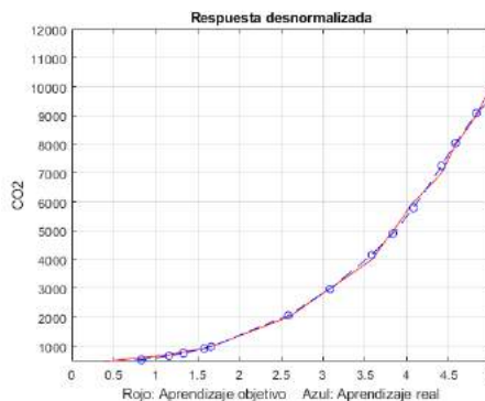
Figura 4. Respuesta de la red neuronal para el sensor de CO2 MG811.
