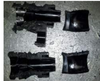
Figura 11. Corte axial mal soldado
