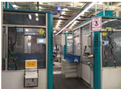
Figura 1. Cabinas de soldadura
