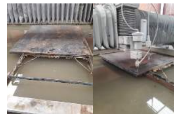
Figura 7. Maquinado en waterjet
