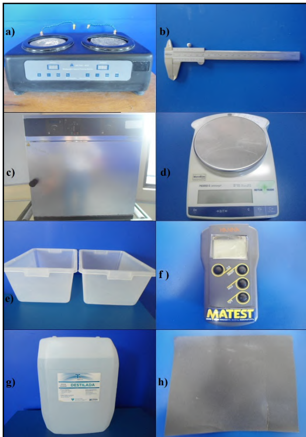
Figura 3. Equipos y materiales empleados en el ensayo de absorción y de densidad: a) Pulidora de muestras; b) Vernier análogo; c) Horno de secado; d) Báscula digital; e) Contenedores de plástico; f) Termómetro digital; g) Agua destilada; h) Lija con tamaño de grano 400.
