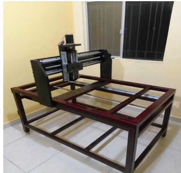
Figura 2. Ensamble del diseño de la estructura mecánica de la maquina CNC
