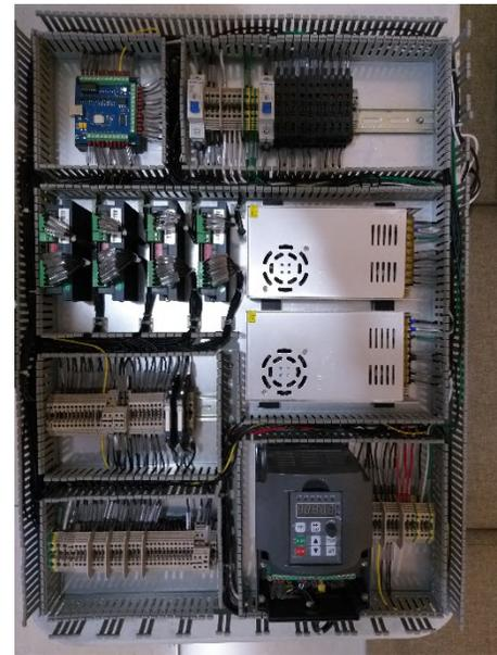
Figura 6. Tablero principal de control y potencia de la máquina CNC
