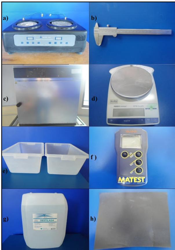
Figura 3. Equipos y materiales empleados en el ensayo de absorción y de densidad: a) Pulidora de muestras; b) Vernier analógico; c) Horno de secado; d) Báscula digital; e) Contenedores de plástico; f) Termómetro digital; g) Agua destilada; h) Lija con tamaño de grano 400.
