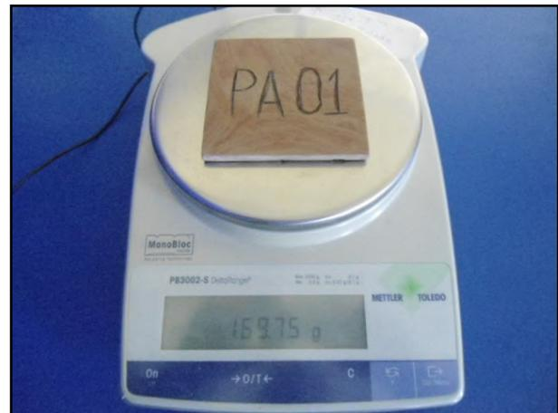
Figura 9. Fotografía del peso saturado de la probeta PA01.
