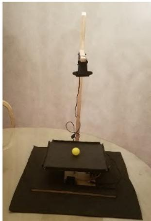
Figura 6. Sistema físico del Ball&Plate.
