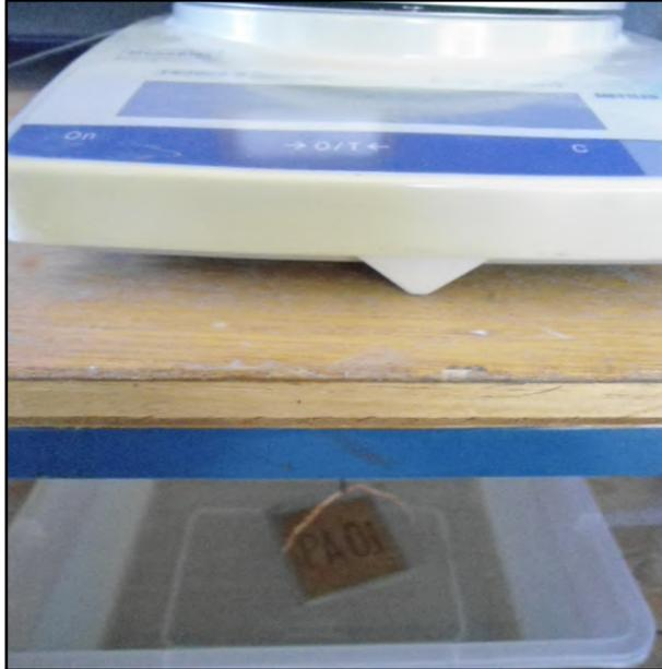
Figura 10. Fotografía del peso suspendido de la probeta PA01.
