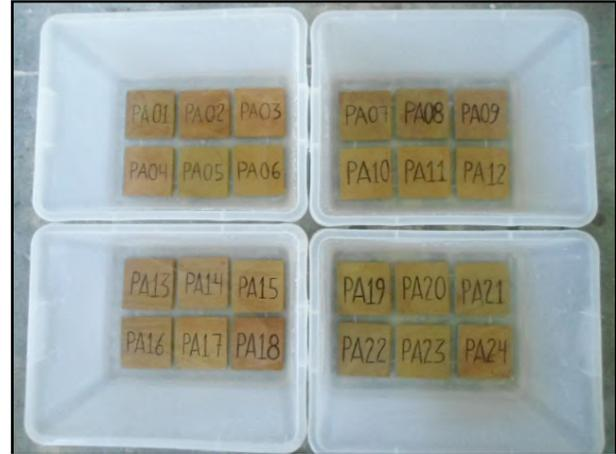
Figura 8. Fotografía de las 24 probetas inmersas en agua destilada.
