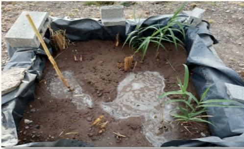
Figura 2. Incorporación de las plantas de carrizo y juncos, con saturación de agua corriente en el sustrato inerte.
