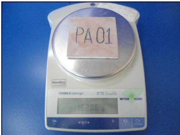
Figura 7. Fotografía del peso seco de la probeta PA01.
