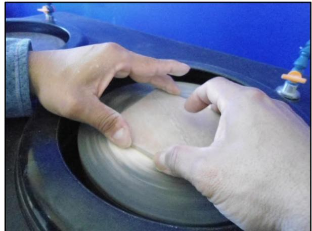
Figura 4. Fotografía del pulido de una probeta.
