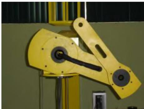
Figura 1. Robot experimental de dos grados de libertad
