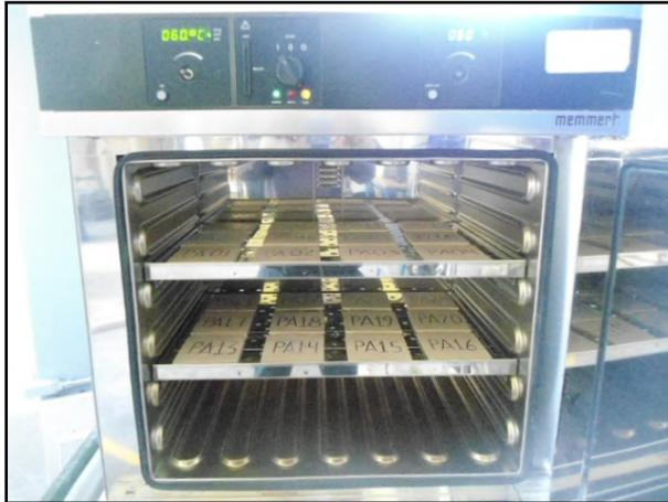
Figura 6. Fotografía del secado de las probetas.
