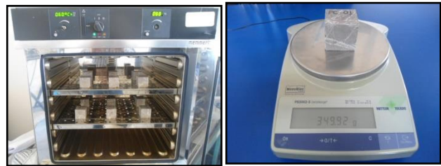
Figura 6. a) Secado inicial; b) Peso seco inicial de la probeta PC01.
