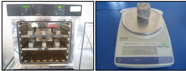
Figura 11. a) Secado final; b) Peso seco final de la probeta PC01.
