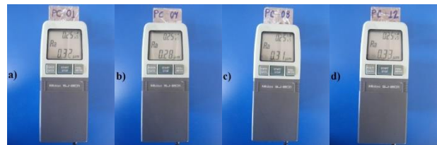
Figura 7. Rugosidad inicial en el punto 5 de las probetas: a) PC01; b) PC04; c) PC08; d) PC12.
