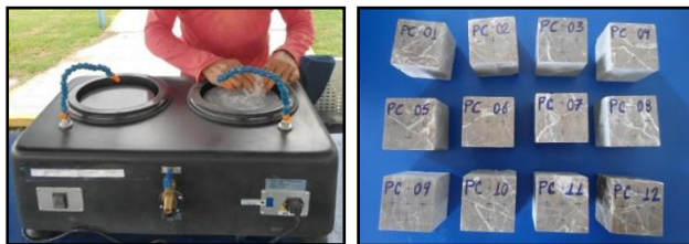
Figura 5. a) Lijado de una probeta; b) Probetas numeradas y marcadas.
