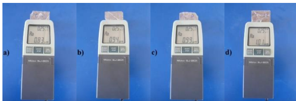
Figura 12. Rugosidad final en el punto 5 de las probetas: a) PC01; b) PC04; c) PC08; d) PC12.
