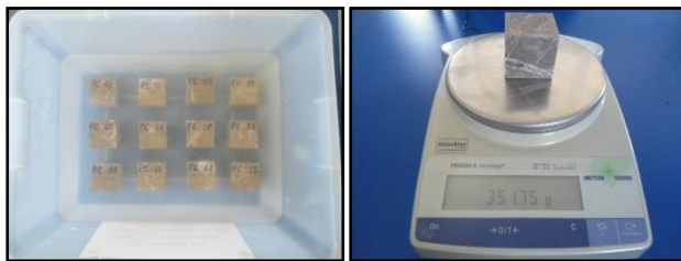
Figura 9. a) Probetas sumergidas en solución; b) Peso saturado de probetas PC01.
