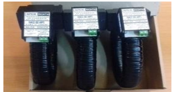
Figura 5. Transformadores flexibles de 600 Amps instalados
