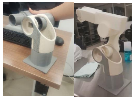
Figura 3 Dos vistas del ensamble de algunas piezas del prototipo elaboradas en impresora 3D.
