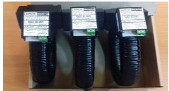
Figura 5. Transformadores flexibles de 600 Amps instalados
