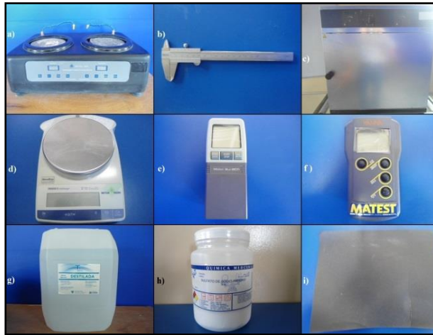
Figura 4. Equipos y materiales empleados en la prueba de cristalización de sales: a) Pulidora marca MTI; b) Vernier analógico marca MITUTOYO; c) Horno de secado marca MEMMERT; d) Báscula digital marca METTLER TOLEDO; e) Rugosímetro marca MITUTOYO; f) Termómetro digital marca MATEST; g) Agua destilada; h) Sulfato de sodio anhidro; i) Lijas con tamaño de grano 400
