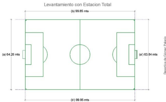
Figura 4. Levantamiento topográfico con estación total.
