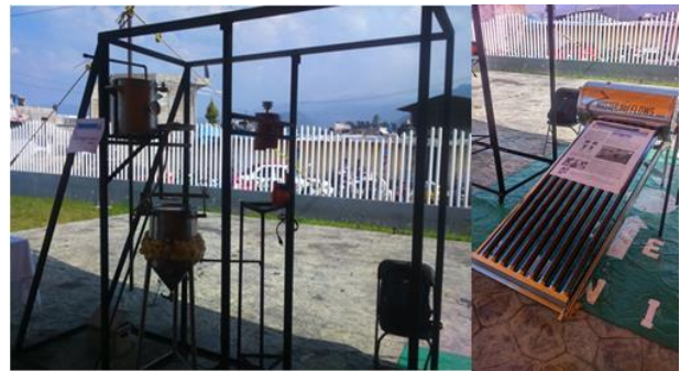
Figura 15. Estructura, sistema auxiliar de generación, sistema de producción de biogás y sistema termosolar.
