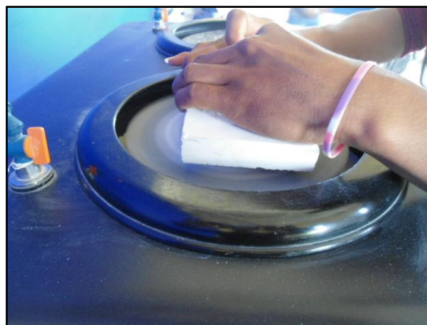
Figura 5. Fotografía del pulido de una probeta.
