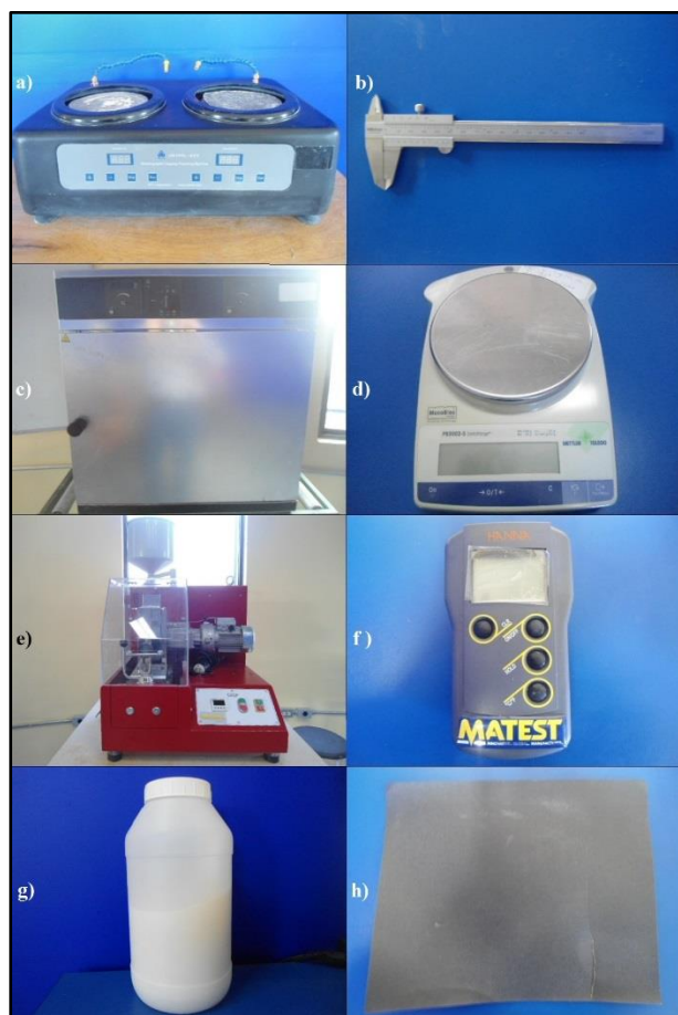
Figura 4. a) Pulidora marca MTI; b) Vernier analógico marca MITUTOYO; c) Horno de secado marca MEMMERT; d) Báscula digital marca METTLER TOLEDO; e) Máquina de abrasión de disco ancho marca MATEST; f) Termómetro digital marca MATEST; g) Arena de corindón grado 80; h) Lija con tamaño de grano 400.
