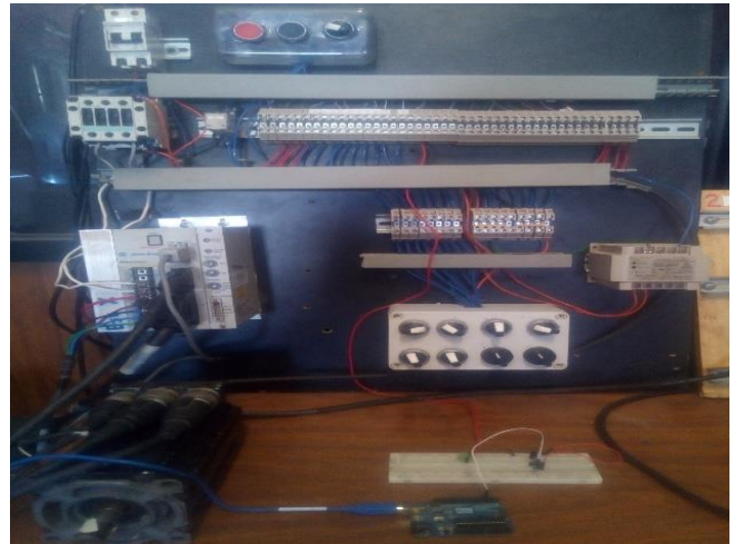
Figura 13 Servosistema trabajando con Arduino uno
