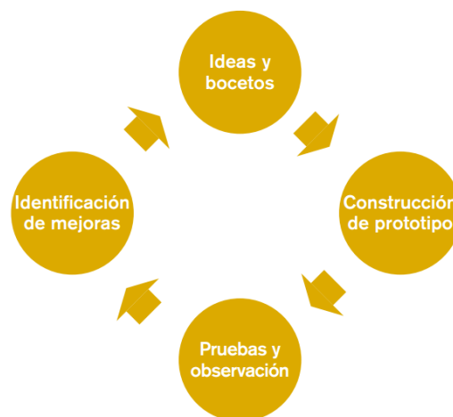
Figura 1 Proceso iterativo para la construcción de prototipos.
