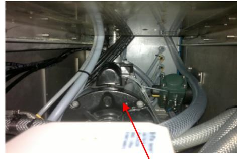
Figura 4. Bomba ubicada en compartimiento de máquina
