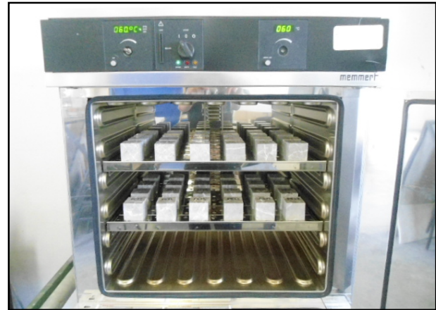
Figura 9. Probetas dentro del horno de secado.
