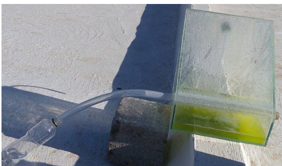
Figura 3. Prototipo de destilador solar de la UPRL en proceso de destilación.
