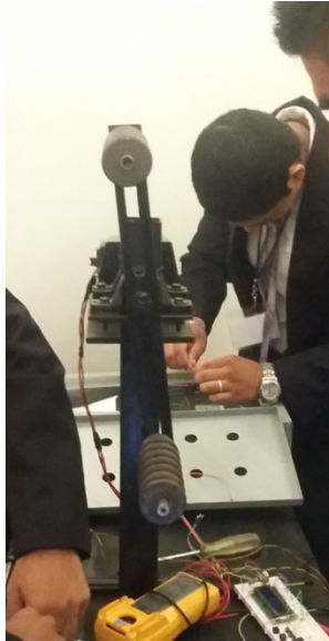
Figura 8. Ajuste del alambre en máquina bobinadora semiautomática
