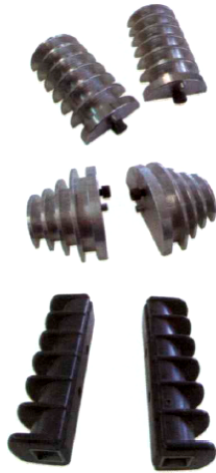
Figura 2. Diferentes tipos de moldes para la construcción de bobinas [5]
