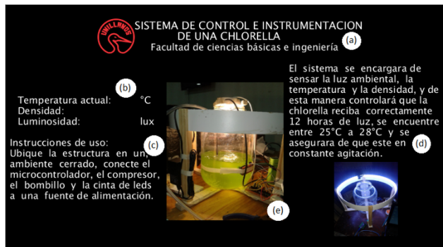
Figura 6. Interfaz, (a)presentación, (b)valores sensados, (c)instrucciones de uso, (d)condiciones ideales para el crecimiento de la chlorella, (e)fotografías
