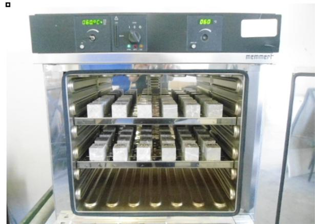
Figura 9. Probetas dentro del horno de secado.
