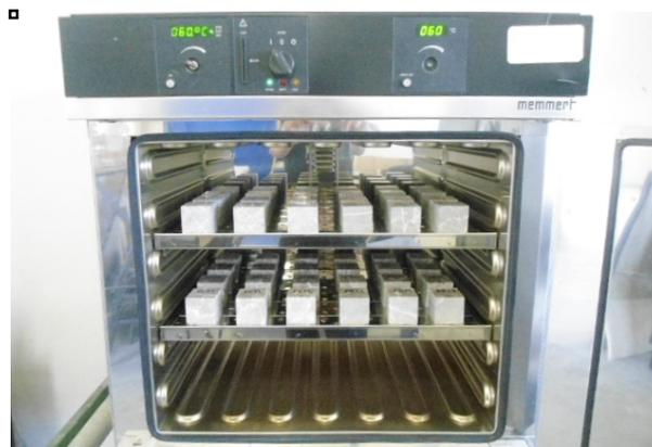
Figura 3. Probetas dentro del horno secado.
