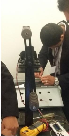
Figura 8. Ajuste del alambre en máquina bobinadora semiautomática
