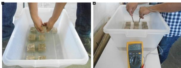
Figura 8. a) Lavado de las probetas; b) Medición de la resistividad
