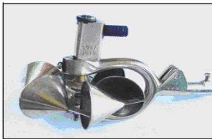
Figura. 1. Medidor de velocidad electromecánico modelo Price
