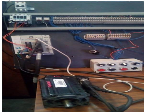
Figura # 12 Prototipo de control de un Servomotor.
