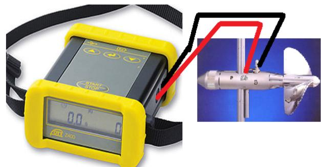
Figura 8. Medidor OTT con molinete horizontal
