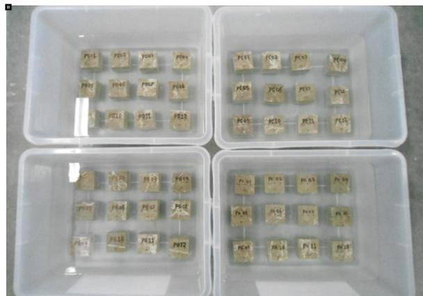
Figura 5. Probetas sumergidas en las soluciones.
