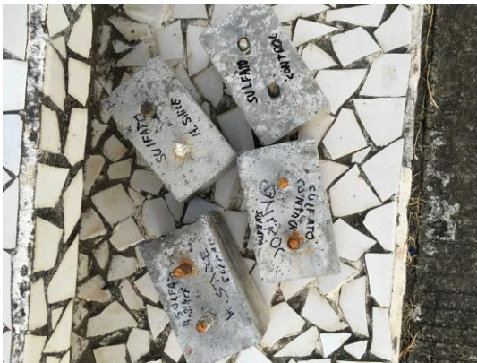
Figura 7. Especímenes cortados para realizar estudio de carbonatación.
