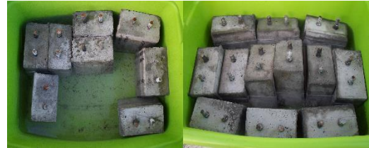
Figura 4. Descimbrado y etapa de curado de los especímenes de prueba.
