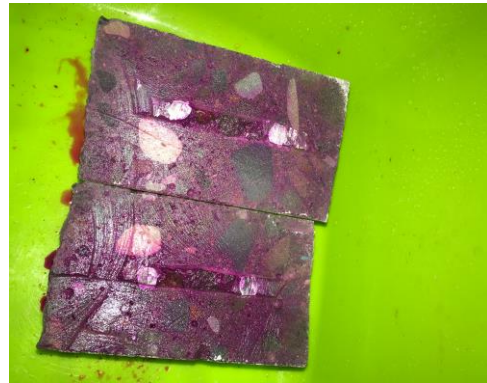
Figura 8. Especímenes expuestos a estudio de carbonatación.
