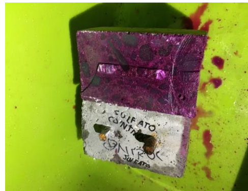
Figura 9. Cara inferior expuesta a Fenolftaleína.
