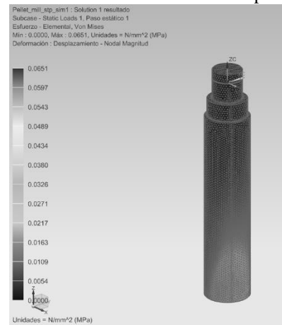
Figura 7. Resultados del análisis estático del eje sometido a torsión
