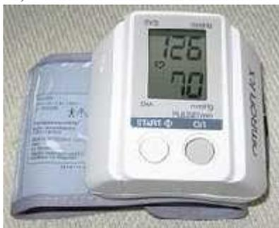
Figura 1. Esfigmomanómetro usado para medir la presión arterial
