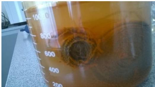
Figura 5. Malla en solución de HNO<sub>3</sub>.
