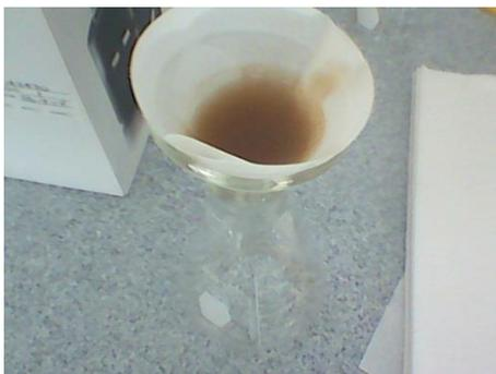
Figura 2. Filtro de 25  $\mu\text{m}$ .
