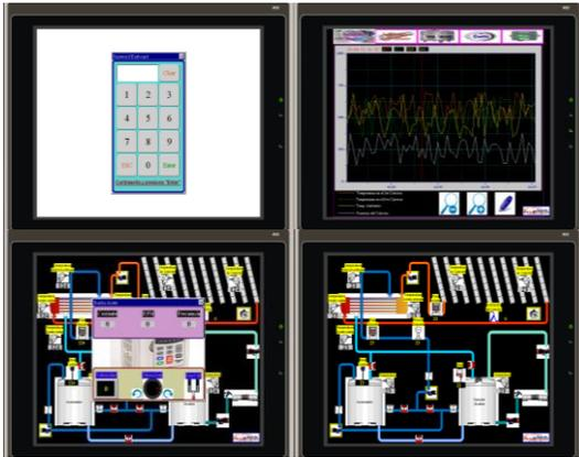
Figura 17. Interfaz para el manejo de colectores solares.
