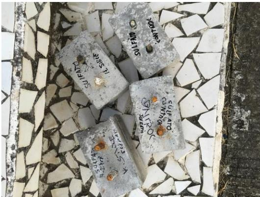
Figura 7. Especímenes cortados para realizar estudio de carbonatación.
