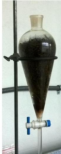
Figura 1. Embudo empacado con alambre.
