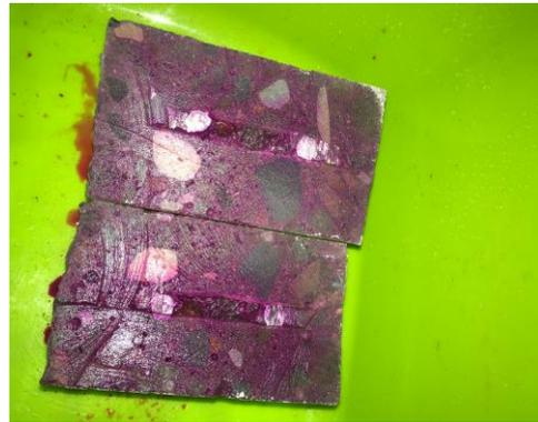
Figura 8. Especímenes expuestos a estudio de carbonatación.
