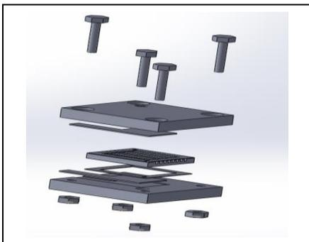
Figura 9. Componentes de la celda de combustible.
