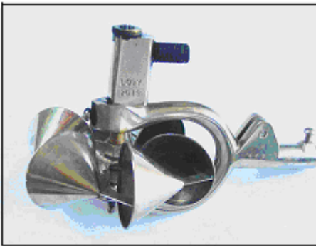
Figura.- 4. Medidor de velocidad electromecánico modelo Price
