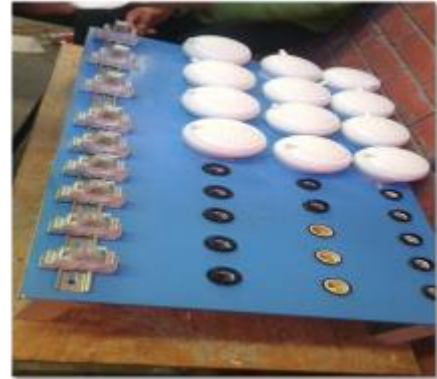
Figura 7. Banco de carga.
