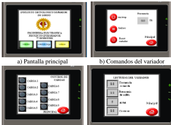
Figura 11. Pantallas de navegación y control de la HMI.
