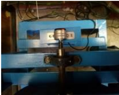
Figura 16. Montaje de encoder.
