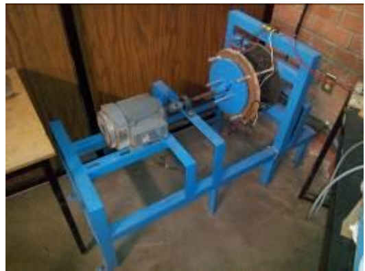
Figura 3. Motor-Generador montados en estructura.
