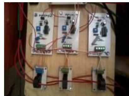
Figura 15. Acondicionamiento de señal de las corrientes.
