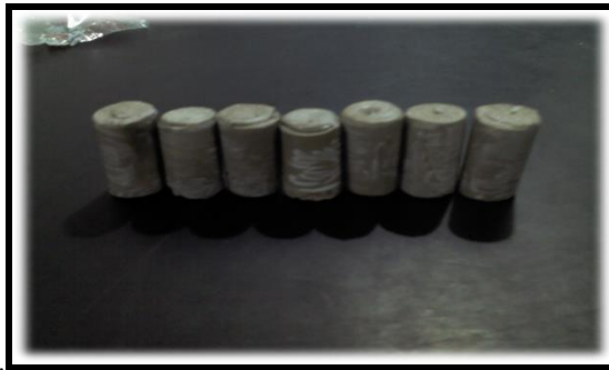
Fig.8. Probetas bajo las Normas ASTM D695. (Fuente Propia)
