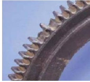
Figura 5 (Desgaste por fatiga superficial) (11)
