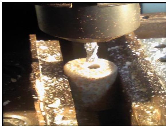
Fig. 12. Maquinado de bujes de 1 Pulg. En PET reciclado.(Fuente: Lab. De Manufactura del ITSSAT).
