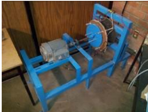
Figura 3. Motor-Generador montados en estructura.
