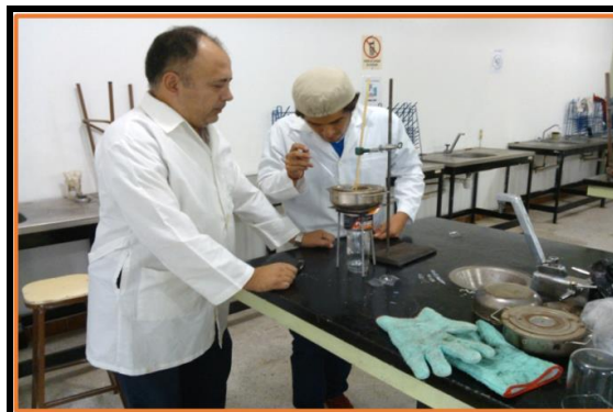
Fig. 11. Fundiendo PET a 260°C. En Lab.Química en el ITSSAT. (Fuente Propia).
