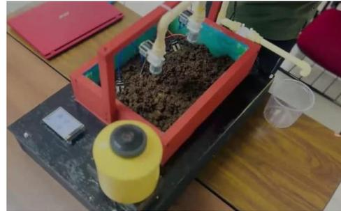
Finalmente, como se muestra en la Figura 12, se representan las conexiones de los sensores de humedad, temperatura y nivel al controlador Arduino MEGA 2560. Estas variables fueron utilizadas para el control automático de la activación de las electroválvulas y la bomba encargada de suministrar el riego. El sistema fue diseñado para mantener la humedad en un rango óptimo de 65 % a 80 % y la temperatura entre 15 °C y 25 °C, condiciones adecuadas para el desarrollo del proceso de lombricompostaje.
