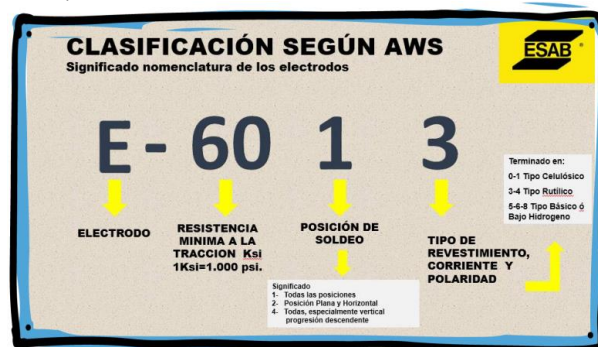
Figura 3 Clasificación según AWS (Significado nomenclatura de los electrodos).
