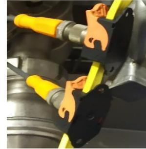
*Nota. A los conectores que van en el cable amarillo se les llama coloquialmente "Conectores Vampiro".*
