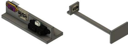
La prueba se llevó a cabo con la placa Arduino Uno que tiene como componente principal un microcontrolador ATMEGA328P al cual se conectaron cada uno de los sensores de manera individual. Para recabar los datos se programó una interfaz visual en Python a través de la librería Tkinter.
