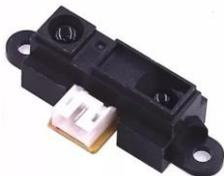
Las principales características de este sensor se presentan en la Tabla 3, Este sensor es adecuado para aplicaciones donde se requiere una medición precisa en distancias cortas, como en sistemas robóticos, detección de proximidad en dispositivos de seguridad y automatización de procesos.
