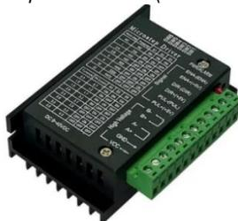
El controlador de motores a pasos TB6600 puede controlar motores a pasos bipolares. Se distingue por su capacidad para controlar de manera precisa la velocidad y la dirección de rotación de un motor en pasos. Aplicaciones que requieren un control detallado del movimiento, como impresoras 3D, máquinas CNC y sistemas de automatización, utilizan con frecuencia este controlador. Las características principales de este controlador se describen en la Tabla 6.
