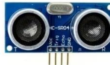
Este sensor es ideal para aplicaciones donde se requiere una medición de distancia precisa en un rango medio, como en proyectos de robótica para evitar obstáculos, sistemas de control de presencia o automatización de procesos que requieren detección de objetos a corta y media distancia. La Tabla 4, presenta sus principales características.
