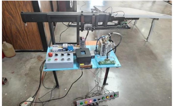
En caso de que sea aprobado entonces permite el acceso y las partes móviles comienzan a retraerse hasta entrar casi por completo dentro de la guarda secciones. Este procedimiento de retracción, se muestra en la Figuras 22 y 23. Después, el controlador espera unos segundos, simulando así el tiempo que tarda un vehículo en pasar, y finalmente el controlador activa el actuador y la pluma extiende nuevamente sus secciones para volver a bloquear el paso y esperar la lectura de un nuevo tag.
