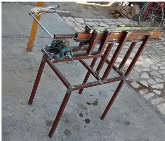
En la Figura 18, se muestra el prototipo de la pluma ya con el motor y el drive montados. Asimismo, se puede observar la cadena de acoplamiento entre el motor y el eje de engranes.
