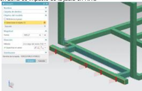
Figura 12 Carga en zona de impacto de la jaula en NX©
