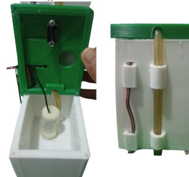
Figura 24. Montaje del depósito de agua.
