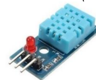
Figura 5. Sensor de temperatura y humedad DHT11(Fuente: Digikey)
