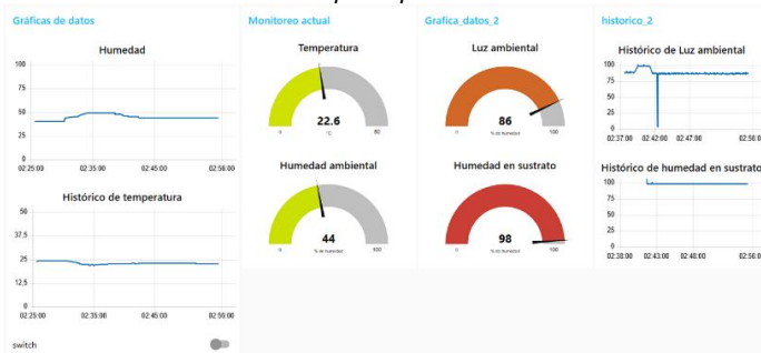
Figura 28. Interfaz visual o dashboard del prototipo en Node-Red®
