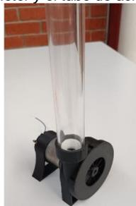
Las pruebas se repitieron con diferentes objetos y objetos tomando como muestra el voltaje que requería el actuador para que el objeto partiera del reposo. Los resultados se ven en la Tabla 3.
