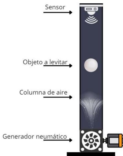
El principio de funcionamiento se basa en la tercera ley de Newton, que establece que "a toda acción corresponde una reacción igual y opuesta". En este caso, la acción de expulsar aire a presión hacia arriba genera una reacción que empuja hacia abajo al objeto, creando así la fuerza de levitación. Es importante destacar que la estabilidad en el prototipo depende de mantener un flujo de aire constante y uniforme, así como de controlar factores como la presión, la distancia y la carga del objeto.
