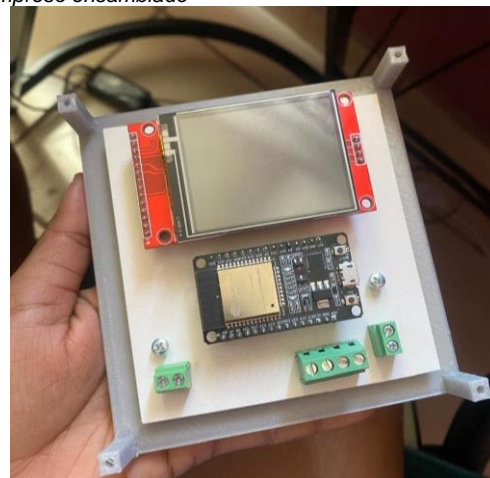
Figura 4. Circuito impreso ensamblado
